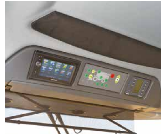
Beleuchtungspanel, optionales Multimediasystem mit CD, DVD, USB, und SD-Laufwerken, Navigation und Bluetooth, Klimautomatik
