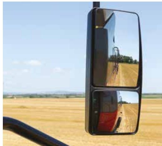
Exzellente Sicht auf die Seiten der Maschine durch zweigeteilte, verstellbare Spiegel
