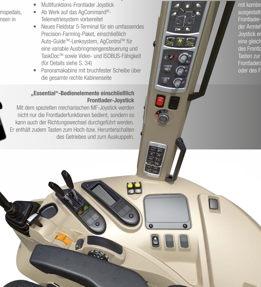
Mechanisch gesteuerter, multifunktionaler Lader-Joystick
